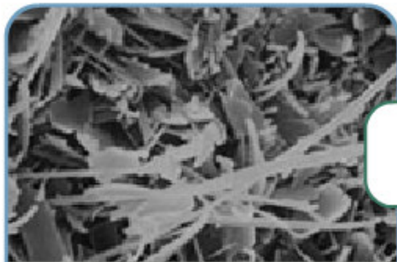
Nagyporozitású massa 10.000-szeres nagyításban
